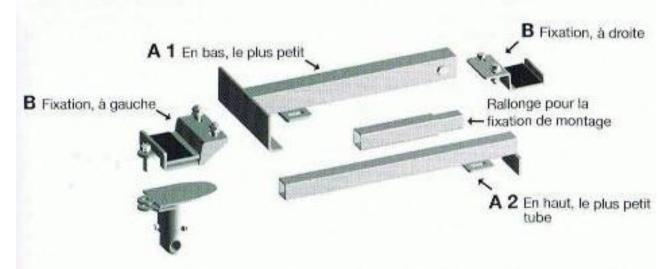
Pour monter la fixation de suspension du Camper Trolley sur la caravane, commencer par emboîter ensemble les deux tubes de stabilisation A1 et A2, puis les placer en hauteur à l'intérieur des longerons. Visser alors sans serrer les fixations droite et gauche (la droite et la gauche se voient au niveau de la fermeture à bille sur la barre de remorquage).
