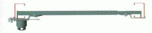
Pousser alors toute la fixation de suspension aussi loin sur les longerons que possible pour augmenter au maximum le poids qui repose sur le Camper Trolley, mais en s'assurant cependant que le montage et le démontage du Camper Trolley se fait sans difficulté.
