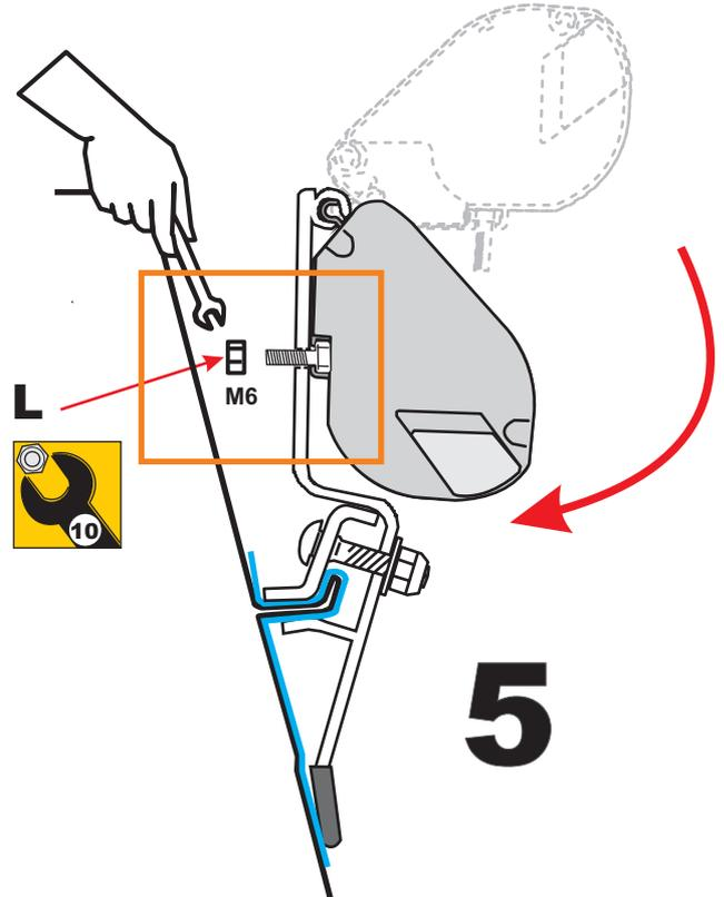
DE **ACHTUNG** Regelmäßig die Befestigung der Halterungen kontrollieren. Achten Sie vor allem nach dem ersten Sicherstellen darauf, dass sich die Haltebügel nicht verschoben haben.
