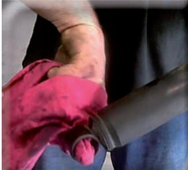
Enlever la peinture, la rouille et les dépôts de caoutchouc des éléments. Inspecter pour rechercher d'éventuels dommages, ou des éléments tordus avant d'installer les Silent Blocs NOLATHANE.
