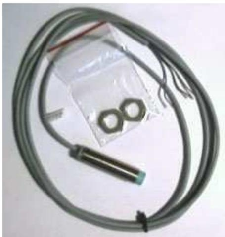
Ce type de sonde est préconisé pour sa solidité et ses caractéristiques techniques. La sonde inductive "3 fils" se monte de la même manière qu'une sonde standard "2 fils" sachant que la distance de détection est étendue de 0,5 mm à 4 mm. Vérifier que l'indicateur de la sonde s'allume lors du passage d'une tête de vis devant la sonde.
